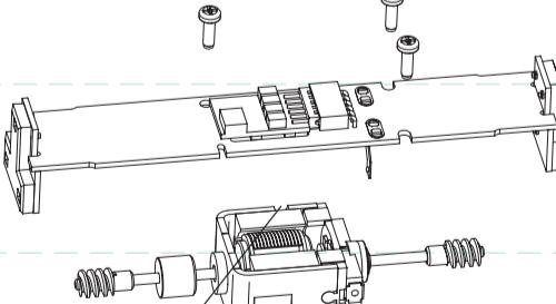
Motorkerbe und Bohrung nach vorne
